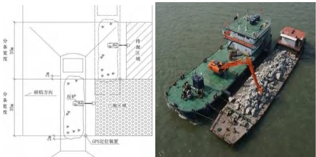
图 2.4.2-7 自航平板驳配反铲抛填平面示意图
