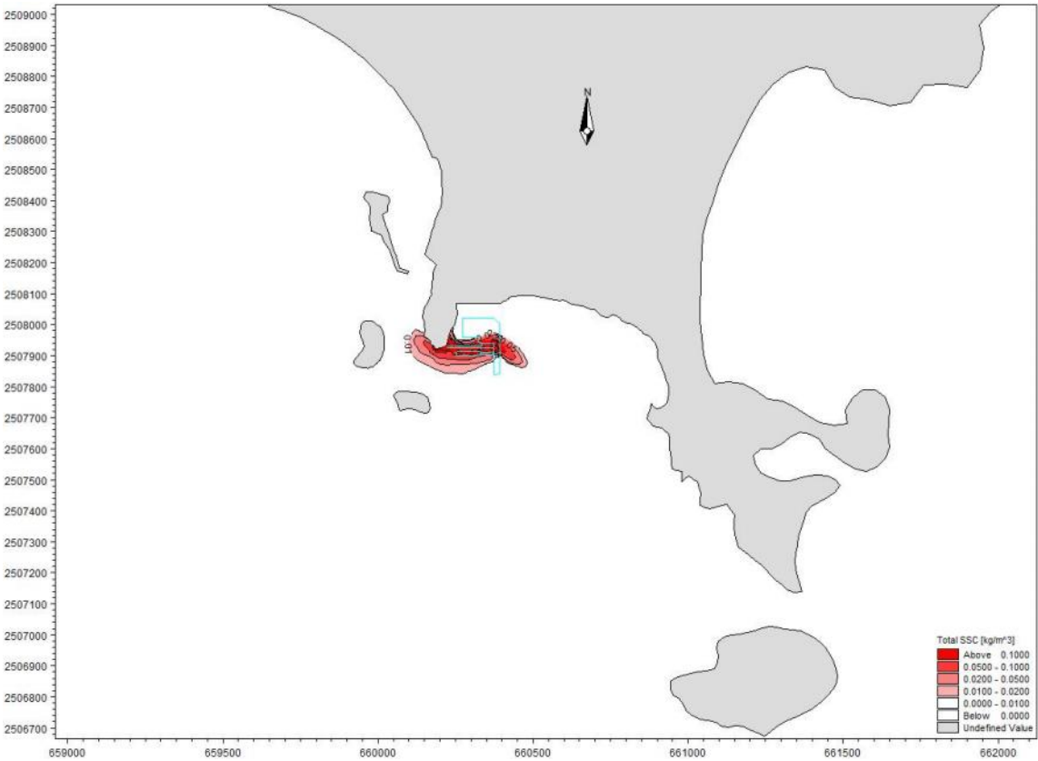
图 7.3.3-1 防波堤施工产生悬沙增量包络线图
